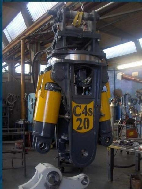
Il corpo centrale viene mosso dall'escavatore ed inserito nel perno del jaws scelto; il perno dopo viene bloccato.
