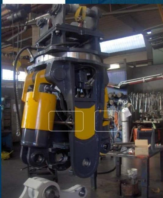
Per fare il cambio dei jaws ancora più velocemente e semplicemente, abbiamo studiato un sistema di blocco dei cilindri del corpo centrale, che permette di mantenere i due cilindri nella posizione ideale per l'inserimento dei due perni sui jaws.
